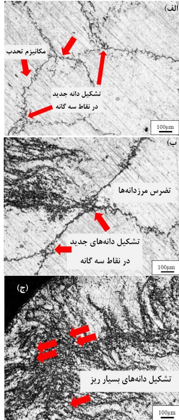
شکل (۵): ریزساختار نمونه آزمایش پیچش گرم آلیاژ SP-700 در دمای ۸۵۰°C با افزایش میزان کرنش از مرکز به سطح نمونه (صفحه r-\theta ): (الف): مرکز r_0 ، (ب): شعاع r_1 \approx 1/5 \text{ mm} و (ج): سطح r_2 \approx 3/2 \text{ mm}
