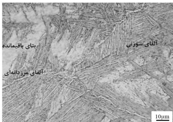
شکل (۱): ریزساختار شمش ریختگی آلیاژ SP-700 پس از همگن‌سازی در دمای 1150^\circ \text{C} و سرمایش در هوا
