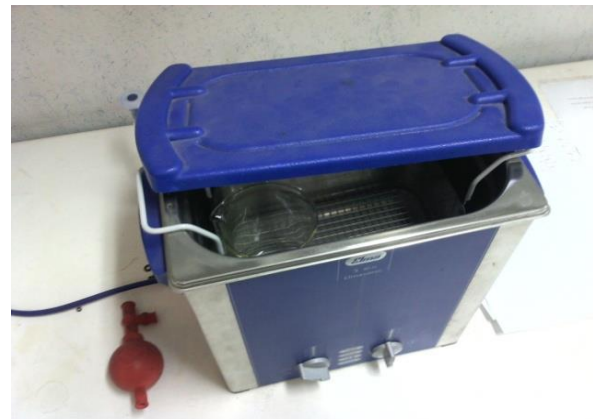
شکل (۲): دستگاه التراسونیک به کار گرفته شده به منظور تکمیل فرایند تشکیل نانوذرات فریت
