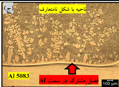
شکل (۵): (الف): تصویر SEM، (ب): تصویر میکروسکوپ نوری از ناحیه با شکل نامتعارف، (ج): تشکیل مذاب یوتکتیک در سمت Al فصل مشترک و (د): الگوی XRD از اتصال نفوذی غیر همجنس ایجاد شده در دمای 440^\circ\text{C} و در زمان 60\ \text{min}
