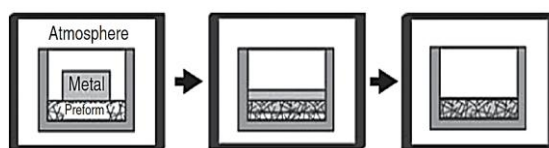
شکل (۱): شماتیک فرآیند رخنه‌دهی تحت نیروی گرانش در فشار خلأ [۸].
