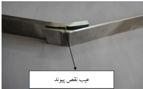
شکل (۱۵): محل شکست در نمونه جوشکاری شده با ۵۰۰ rpm
