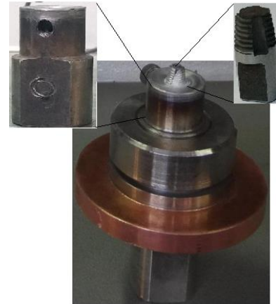
شکل (۲): ابزار جوشکاری شامل: نگهدارنده، شانه و پین.
