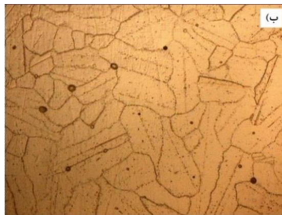
شکل (۱): ریزساختار آلیاژ تکفاز تیتانیوم آلومیناید و الف) پس از ریخته‌گری، ب) پس از همگن‌سازی.
