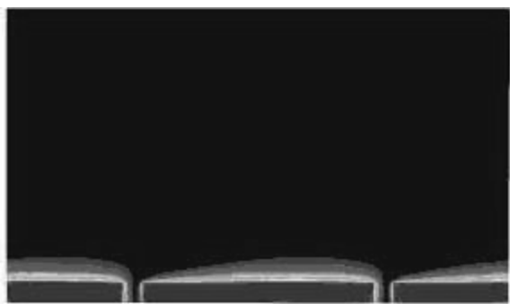
شکل (۱۰): لایه مرزی گرمایی در مسیر جریان هوا از روی سوراخها در آرایش مثلثی
