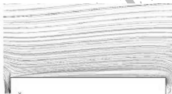
شکل (۲۴): نمایش خطوط مسیر جریان در راستای سوراخها در آرایش مثلثی
