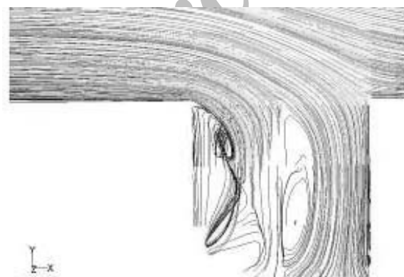
شکل (۱۲): نمایش خطوط مسیر جریان داخل سوراخ در آرایش مربعی
