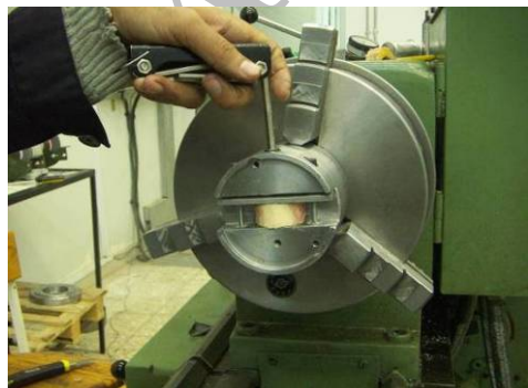
شکل (۴): قرار گرفتن نمونه در فیکسچر و محکم کردن پیچ
