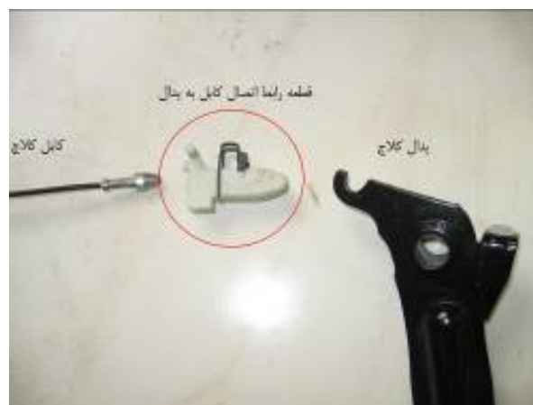
شکل (۱): قطعه رابط سیم کلاچ به پدال کلاچ
