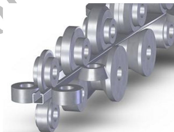
شکل (۱): نمایش تولید پروفیل در فرایند شکل دهی غلتکی سرد
