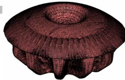
شکل (۸): شماتیکی از بیلت خام بعد از عملیات آهنگری
