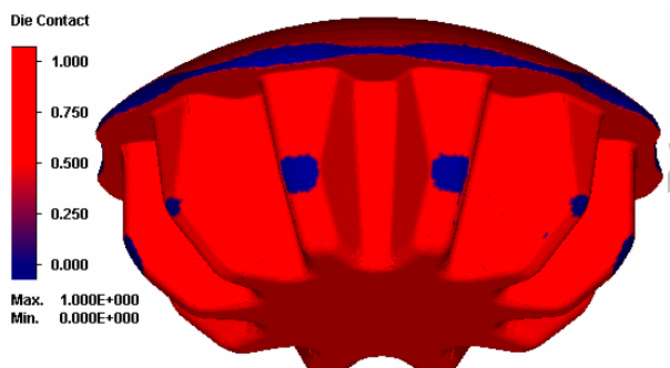
شکل (۱۶): تماس بیلت با قالب مربوط به بیلت با قطر ۲۶ میلیمتر
