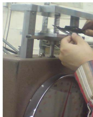
شکل (۲): نیروسنج و فیکسچر متصل به آن جهت تست استاتیکی فنر
