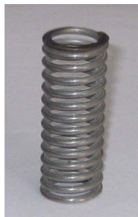
شکل (۱): فنر ساخته شده جهت بررسی میزان افت تنش
