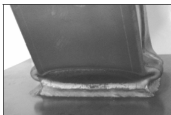
شکل (۵): مود تغییر فرم لوله جدار نازک تحت زاویه ۳۰ درجه [۱۰]
