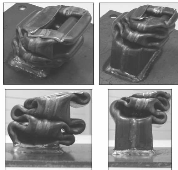
شکل (۳): نمونه تغییر فرم داده شده لوله جدار نازک تحت زاویه ۱۰ درجه [۱۰]
