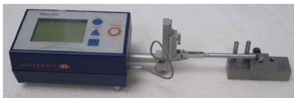
شکل (۱۱): تجهیزات و قید و بند مورد استفاده برای اندازه گیری زبری
