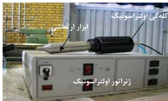
شکل (۱): ابزار ارتعاشی و ژنراتور اولتراسونیک
