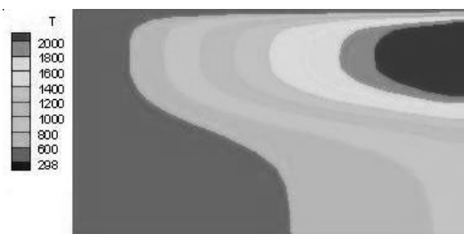
شکل (۶): کانتور دمای شعله برگشته نزدیک دیواره در مرز بین دو ناحیه بالادستی و ناحیه پایین دستی برای زمان t = 0.07 \text{ msec}
