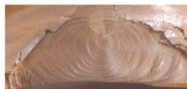
شکل (۱۶): دو نمونه از چرخ‌های وامانده در اثر رشد ترک زیرسطحی [۱۶].
