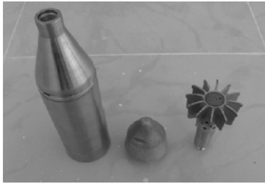
شکل (۱): اجزاء تشکیل دهنده‌ی مدل تست تونل باد (نوک، بدنه و دنباله)
