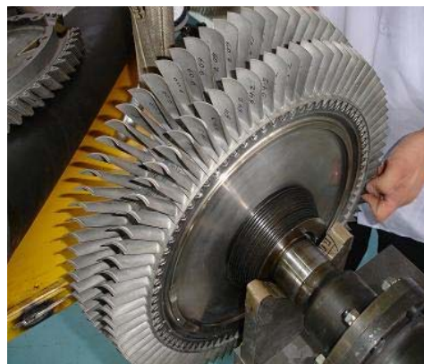
شکل (۳): پره ماشینکاری شده ردیف دوم توربین گازی رستون TA1750
