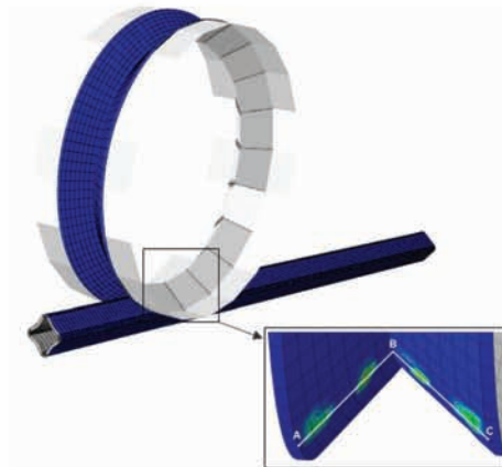
شکل (۹) مسیر "ABC" روی غلتک بالایی ایستگاه پنجم در ناحیه تماس با لوله.
