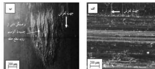
شکل (۱۱) تصویر سطح ورق (الف) و سطح حلقه (ب) پس از آزمایش تحت F_N = 45 \text{ N} ، v = 20 \text{ cm/s} ، روغن شماره ۱۰.
