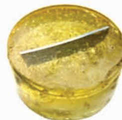
شکل (۶) حالت قرارگیری تکه‌های نمونه در مانته شفاف.
