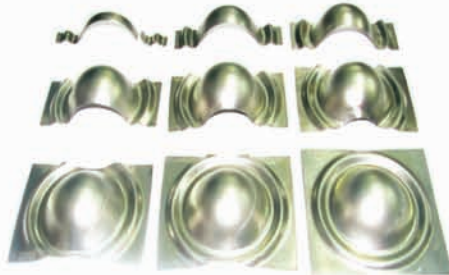
شکل (۳) نمونه‌های تغییر شکل یافته پس از انجام آزمایش اریکسن.
