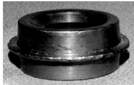
شکل (۱) قطعه متقارن محوری تولید شده با فرایند فورج [۵].
