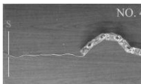
شکل (۲۵) حرکت سرپنتین ربات مارمانند بر روی سطح صاف.
