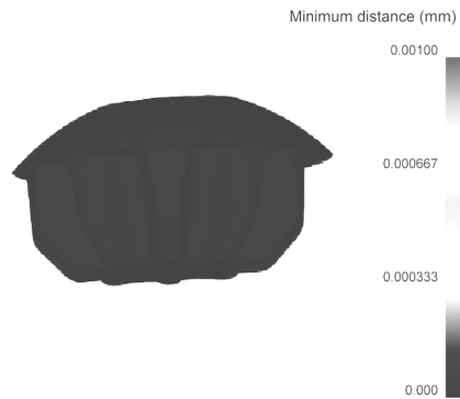
شکل (۲۷) تماس بیلت با قالب مربوط به بیلت با قطر ۲۶ میلیمتر در آهنگری دورانی.
