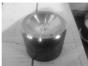
شکل (۹) سنبه و ماتریس ساخته شده از جنس DB.D2 در محیط کارگاهی.
