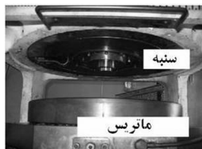
شکل (۱۰) نمای از دستگاه پرس دورانی.
