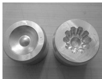
شکل (۶) شماتیکی از سنبه و ماتریس ماشینکاری شده از جنس آلومینیوم توسط ماشین فرز.
