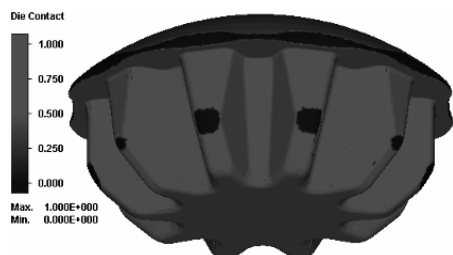
شکل (۲۶) تماس بیلت با قالب مربوط به بیلت با قطر ۲۶ میلیمتر
