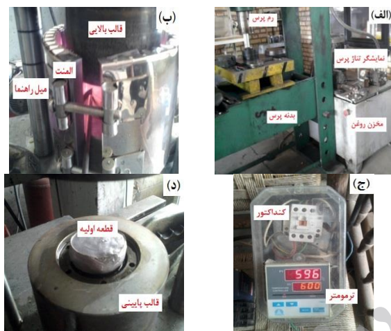
شکل (۲) نحوه قرار گیری اجزای قالب و پرس، (الف) دستگاه پرس، (ب) نحوه قرار گیری ترموکوپل و المنت حرارتی، (ج) سیستم کنترل دما، (د) تغییر شکل شمشال اولیه با دمای ۵۹۰°C به مدت ۱۰mm قبل از فرایند تیگروفورجینگ
