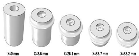
شکل (۱۲) مراحل فروریزش پوسته استوانه‌ای موازی پرشده با فوم در جابجایی‌های مختلف.
