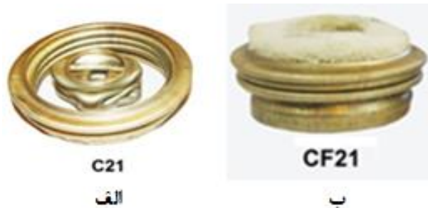
شکل (۶) فروریزش نهایی پوسته‌های استوانه‌ای موازی الف) توخالی و ب) پر شده با فوم
