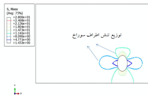
شکل (۷) غلظت تنش اطراف سوراخ برای سوراخ پایین سمت راست
