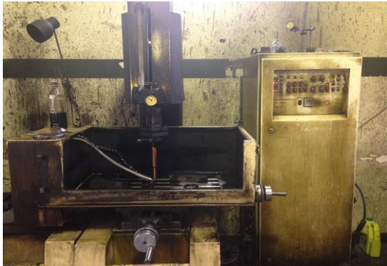
شکل (۲) دستگاه اسپارک پیشراشه مدل ۵۰۱-۵۰A
