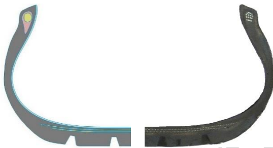
شکل (۴) برش مقطع از تایر مورد نظر (سمت راست) و مدل‌سازی ۲ بعدی تایر در نرم افزار سالیدورکس مطابق با اندازه‌های واقعی (سمت چپ)
