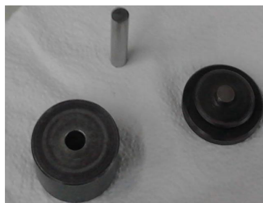
شکل (۲) قالب سخت کاری شده برای انجام فشردگی استاتیکی
