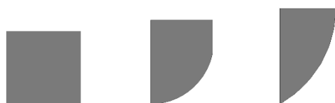
شکل (۸) پرتابه های فلزی به صورت تقارن محوری با سر نفوذ گر به ترتیب از راست به چپ به شکل: اجایو، نیم کروی و تخت
