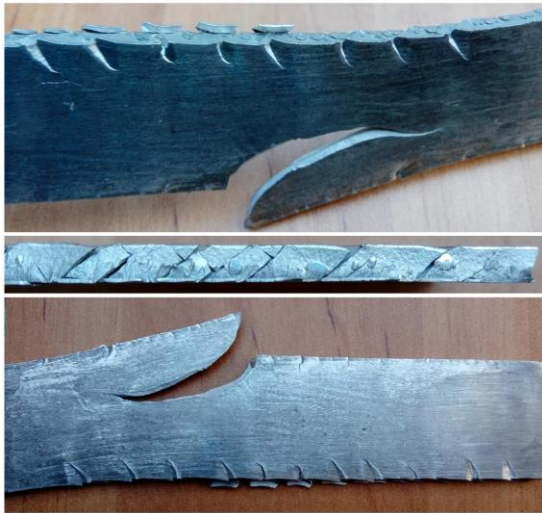
شکل (۱۰) تصویر ترک های ایجاد شده هنگام نورد ورق آلومینیوم منیزیم قبل از آنیل اولیه.
