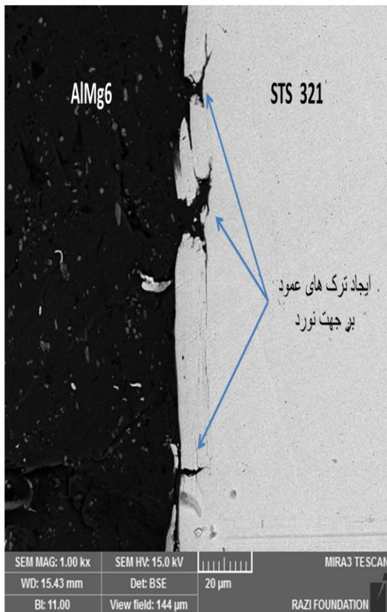
شکل (۴) تصویر فصل مشترک اتصال و ایجاد ترک های عمود بر جهت نورد.
