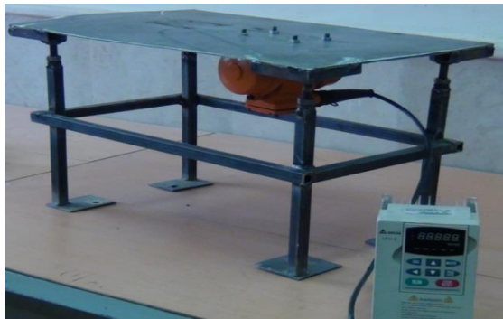
شکل (۲) ویراتور مکانیکی به همراه ارتعاش سنج
