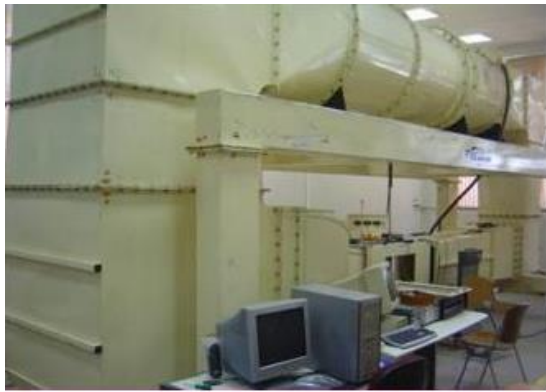
شکل (۲) تونل باد PLINT TE44/C
