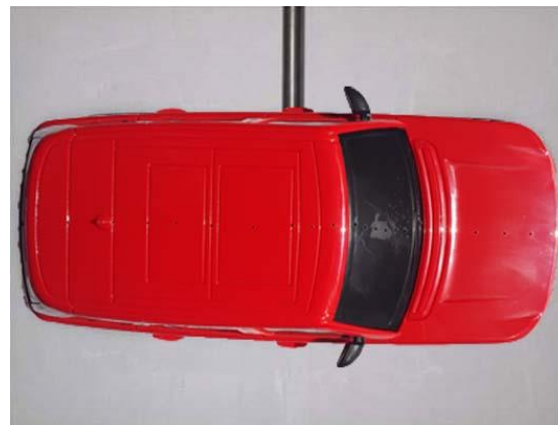
شکل (۴) نحوه اتصال میله تعادل به مرکز ثقل مدل
