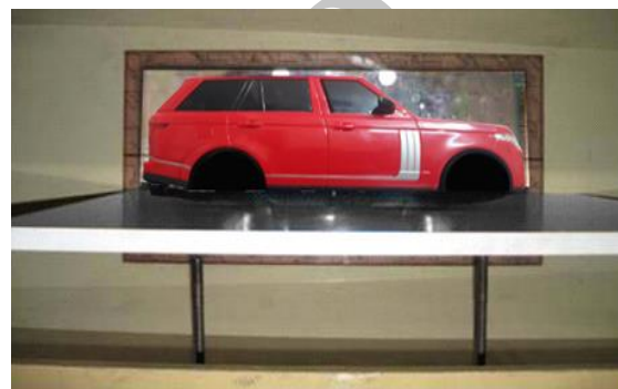
شکل (۵) مدل پایه بدون چرخ در اتاقک آزمون
