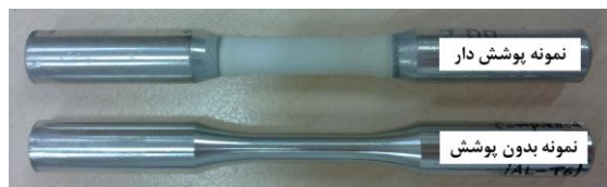
شکل (۱) نمونه‌های آزمون خستگی آلومینیومی با و بدون پوشش.
