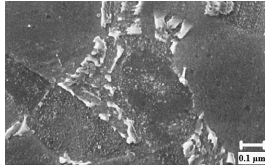
شکل (۵) تصویر SEM ذرات رسوب نانومتری فاز \alpha_2 در دانه های فاز آلفا اولیه موجود در نمونه C.
