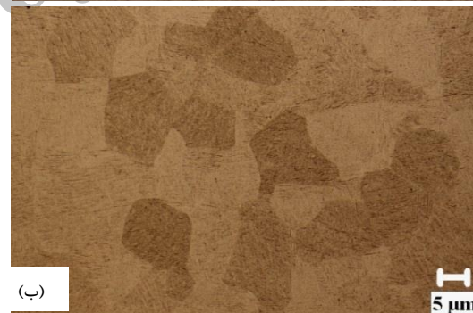
شکل (۲) ریزساختار نمونه‌های آئیل انحلالی و کوئنچ شده، (الف): نمونه آئیل انحلالی شده در دمای 950^{\circ}\text{C} و کوئنچ شده (نمونه A) (ب): نمونه آئیل انحلالی در دمای 1050^{\circ}\text{C} و کوئنچ شده (نمونه D).
