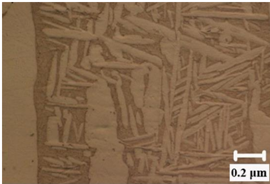
شکل (۶) رسوبات سوزنی شکل فاز آلفا داخل بتا باقی مانده.
