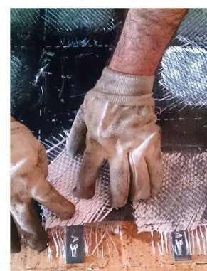
عبور الیاف از دور پین در حین لایه چینی دستی
