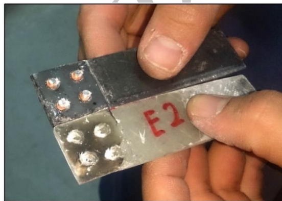
شکل (۳۸) نمونه اتصال گسیخته شده با مد شکست غالب
