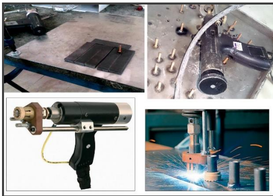
شکل (۲۴) تفنگ مخصوص فرآیند استاد ولدینگ و فرآیند جوشکاری
