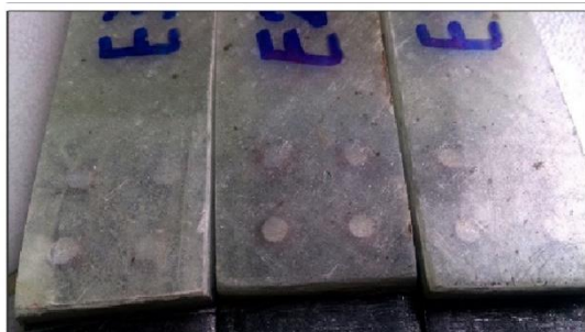
شکل (۲۸) نمونه اتصال آماده شده بعد از برش
