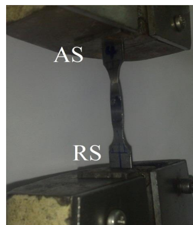
شکل (۸) نمونه کشش (c)، جوشکاری شده با پارامترهای بهینه
