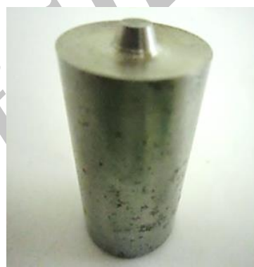
شکل (۱) ابزار کاربرد تنگستن، حاوی پین مخروطی مورد استفاده در تحقیق
