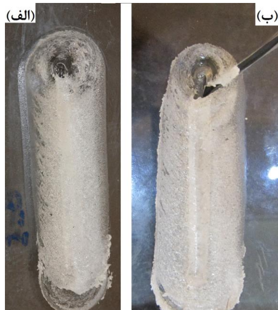
شکل (۱۵) جریان سطحی قطعه کار در نمونه با سرعت خطی (الف) ۲۵ میلی‌متر بر دقیقه و (ب) ۵۰ میلی‌متر در دقیقه جوشکاری شدند.
