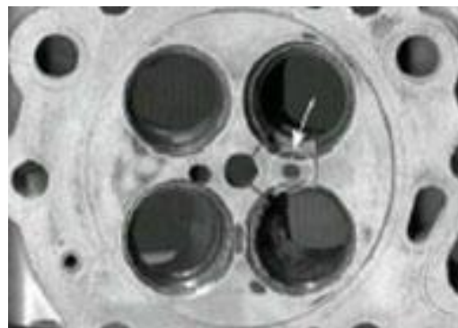
شکل (۱۲) سرسیلندر ترک خورده موتور دیزل [۱۱].
