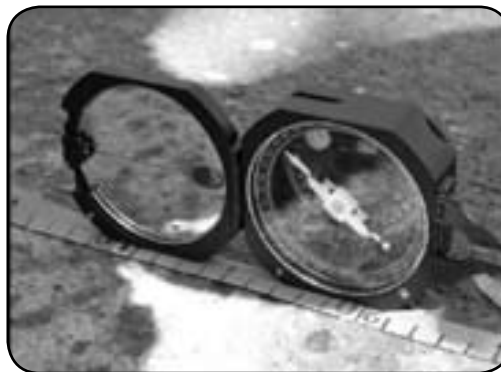
(تصویر شماره ۲) بهره‌گیری از کمپاس مدل به همراه متر جهت اندازه‌گیری شیب
