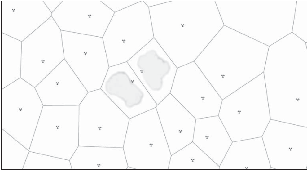
تصویر ۱۱. تشخیص جهت‌های مناسب و نامناسب برای جابجایی یک ایستگاه با استفاده از پلیگون‌های تیسن
