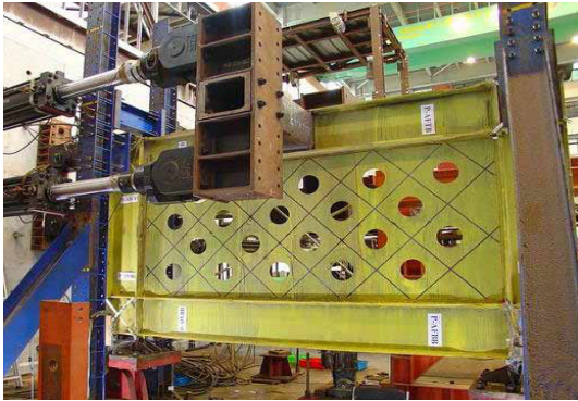
شکل ۳. نمایش نحوه بارگذاری و آرایش باز شو ها در نمونه ویان و برونو
