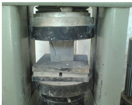
شکل ۴. نمونه بتن در حال شکستن در دستگاه
