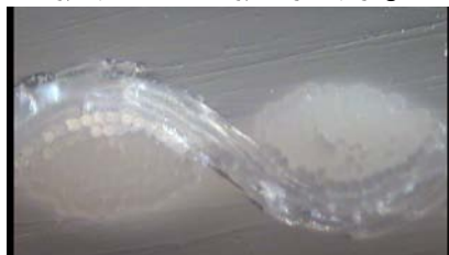
تاب نخ در جهت تار ۲۰۰ پود ۴۰۰ T.P.M (جهت پودی)
