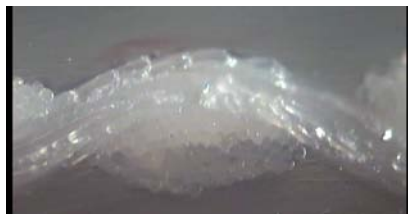
تاب نخ در جهت تار و پود ۲۰۰ T.P.M (جهت پودی)
