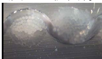
تاب نخ در جهت تار ۸۰۰ T.P.M پود بدون تاب (جهت تاری)
