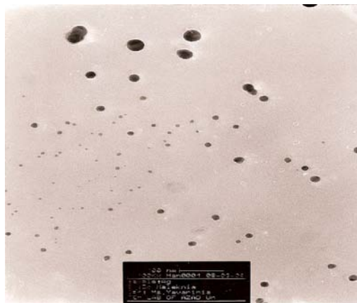
شکل ۳. تصویر TEM محلول کلوئیدی نانو ذرات نقره
