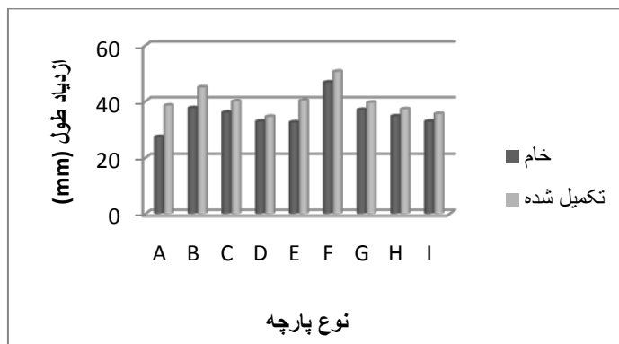
شکل ۱۲. نمودار ازدیاد طول پارچه های فاستونی در حالت های خام و تکمیل در جهت پود
