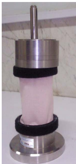
شکل ۱. دستگاه آزمون بازگشت از چروک استفاده شده ساخت شرکت شرلی
