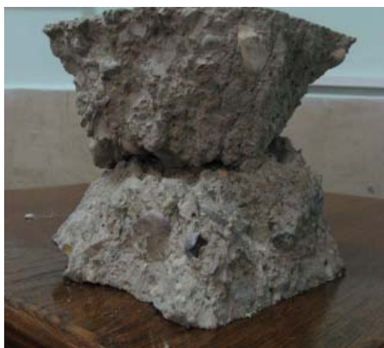
شکل ۳. شکست بتن با استحکام بالا فاقد الیاف
