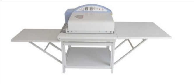
شکل ۱. نمای دستگاه فیوزینگ مداوم Wenzhou Huangli
